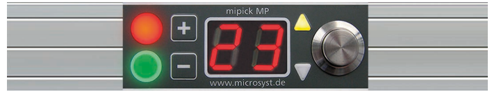
Pick-by-Light Kommissionieranzeige zweistellig mit LED-Display und Anzeige der zu kommissionierenden Menge
