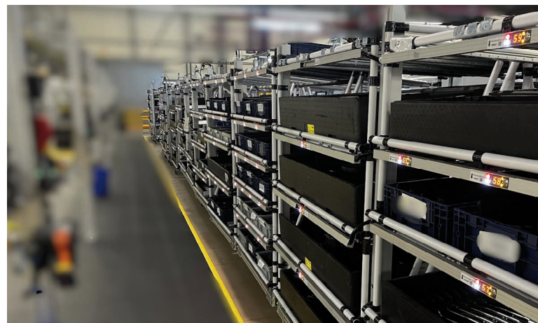
Pick-by-Light Kommissioniersystem bei Firma RESRG in der Kunststoffverarbeitung
