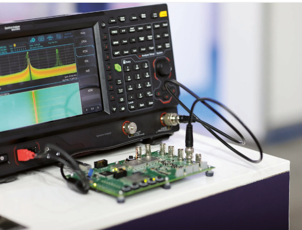
Bei HF-Messungen gehört der gesamte Aufbau zur Bewertung: Prüfling, Anschlüsse, Verkabelung und Messgerät beeinflussen, was am Ende im Spektrum sichtbar wird
