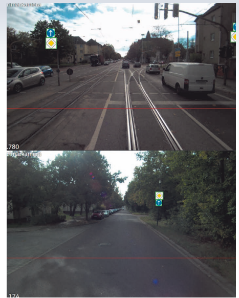
Bild 2: Inventarisierung von Verkehrszeichen während einer Straßenbefahrung mittels Vision AI. ©Stradis GmbH
