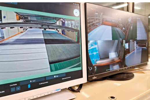
Bild 3: Kontrolle der Planlage von Wellpappe der Firma Packwell mittels DENK Vision AI, umgesetzt mit einer zentral platzierten Kamera über dem Förderband.
