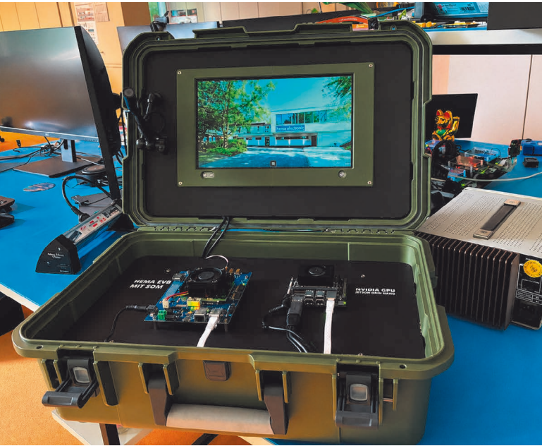
Bild 3: In einem Demo-Aufbau kombiniert hema electronic die Bildvorverarbeitung durch FPGA-basierte System-on-Modules mit einer GPU für KI-gestützte Bildanalysen.
