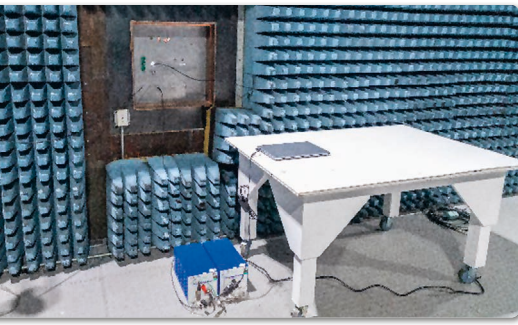
Leitungsgebundene Emissionen in einem Testlabor
