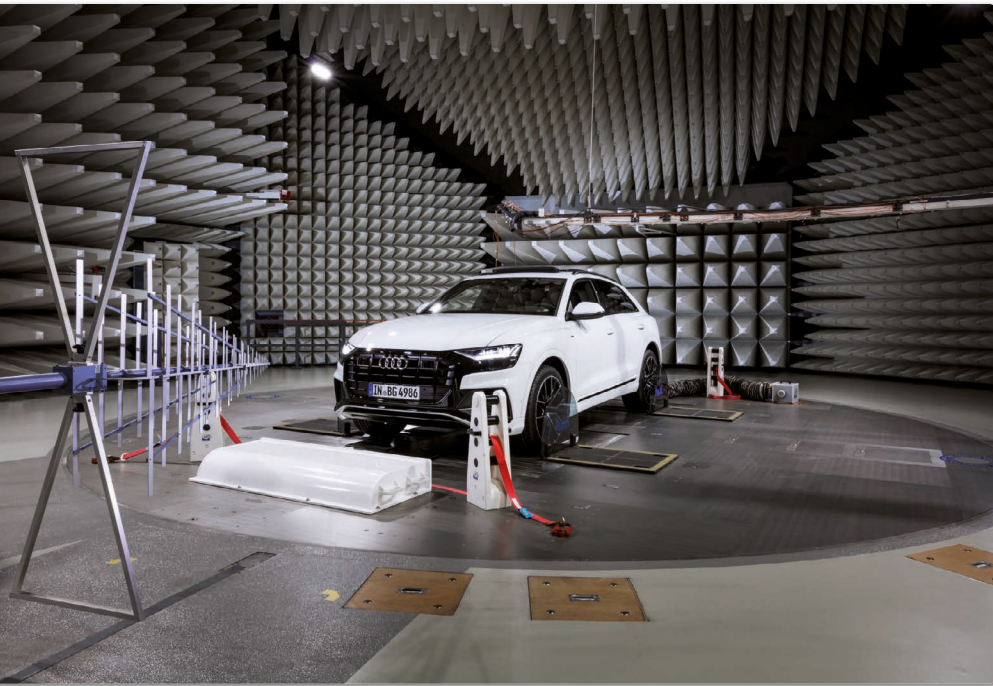
Bild 3: EMV-Kammer für gestrahlte Störfestigkeitsprüfungen an ganzen Fahrzeugen
