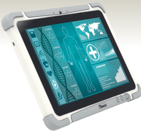
Bild 2: Durch Hot-Swap-Akku und Stift-, Handschuh- und Wet-Touch-Modi kann man das TL Electronic/Winmate M101EK-ME Tablet unterbrechungsfrei und sicher bedienen.
