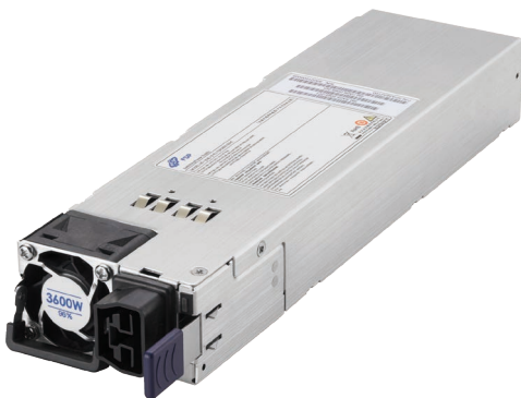
Das FSP3600-20HE ist ein redundantes Netzteilmodul nach CRPS-Standard. Mit einer maximalen Leistung von 3600 Watt und PMBus-Unterstützung ermöglicht es die Kommunikation mit dem Motherboard.
