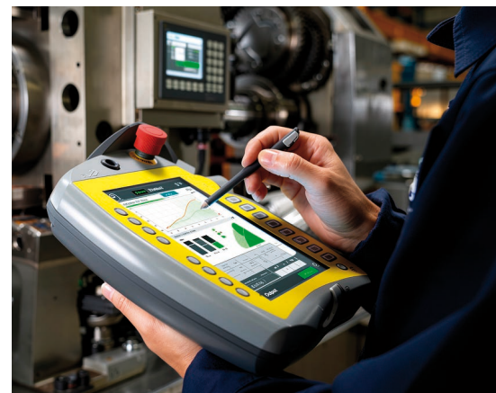
Bild 4: Die Schutzart eines HMI wird nicht durch einzelne Komponenten bestimmt, sondern durch die konstruktive Auslegung des Gesamtsystems.
