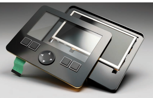
Bild 2: Hybridlösung aus Folientastatur und Silikon-Tastaturen kombiniert eine geschlossene Bedienoberfläche mit verbesserter haptischer Rückmeldung.
