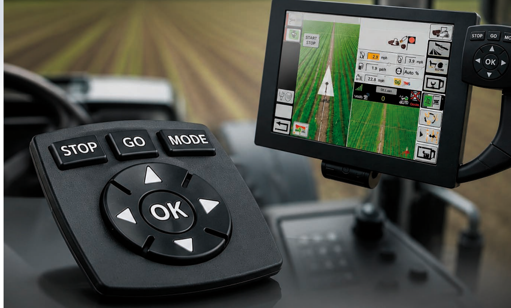
Bild 5: Moderne Arbeitsmaschinen kombinieren Touch-Oberflächen mit haptischen Bedienelementen für eine sichere und ergonomische Bedienung.
