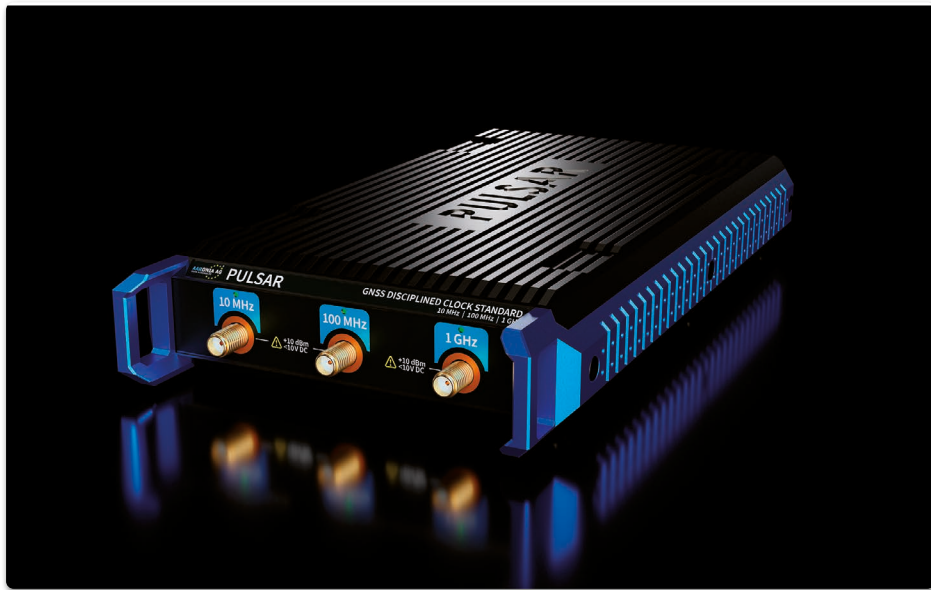
Der neue PULSAR stellt gleichzeitig drei extrem rauscharme, synchronisierte Signale mit 10 MHz, 100 MHz und 1 GHz bereit
