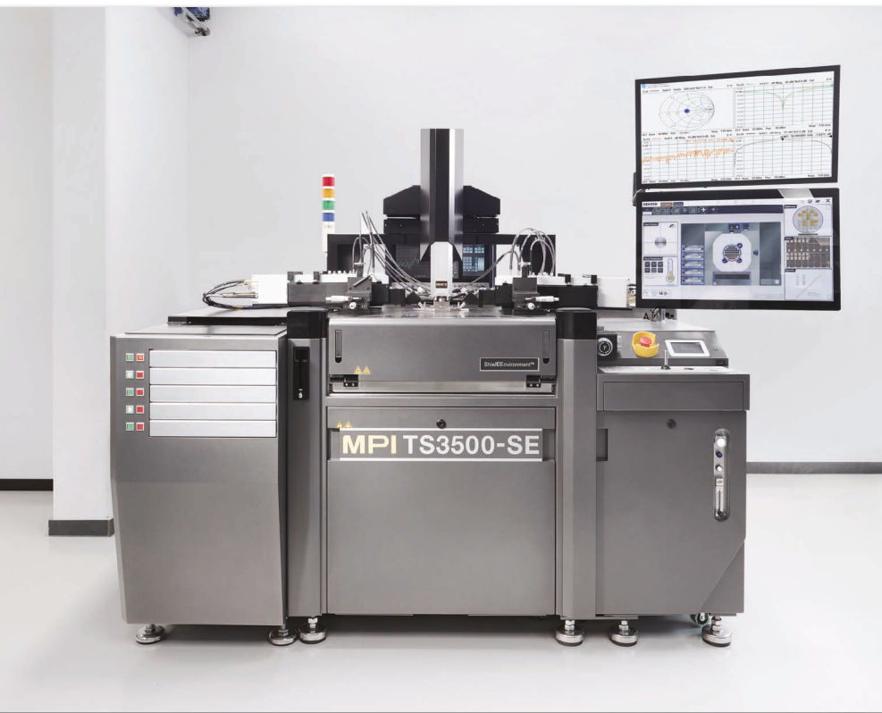
Bild 1: Messaufbau mit Probe-Station und R&S ZNA Vektornetzwerkanalysator
