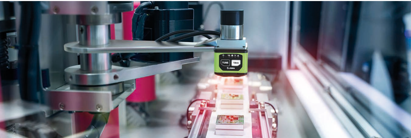
Ein Zebra Fixed Industrial Scanner ermöglicht Hochgeschwindigkeits-Inspektionen in der Elektronikfertigung – von OCR-Prüfungen über Etikettenverifikation bis hin zum Lesen direkt markierter Codes (DPM). Alle Bilder © Zebra Technologies.
