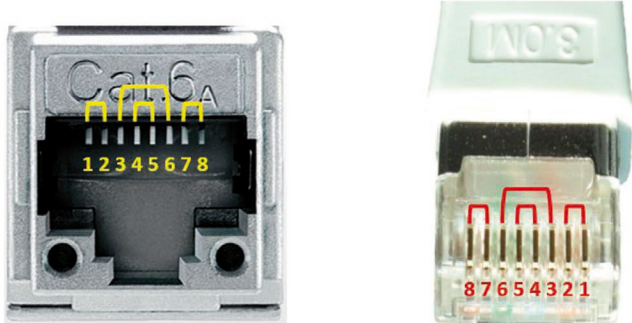
Bild 1: Die in IT-Netzen übliche Pin-/Paarzuordnung von RJ45-Buchse (links) und Stecker (rechts).
