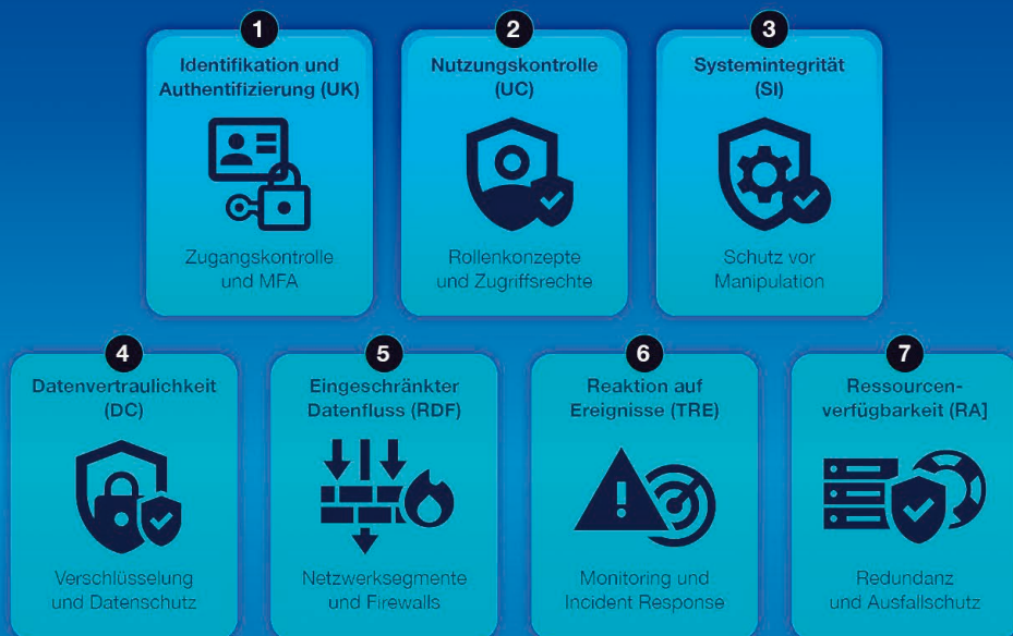
Bild 1: Sieben Maßnahmen der IEC 62443 mit der die notwendigen Safety Level erreicht werden können. © Indu-Sol
