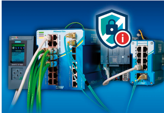
Bild 5: Der PROMesh Diagnose-Switch ist derzeit der einzige managed OT-Switch am Markt, der eine Meldung absetzen kann, wenn eine neue MAC-Adresse im Netzwerk auftaucht. © Indu-Sol
