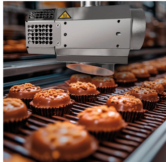
Bild 6: Nahaufnahme, Distanzsensor über Keksförderband bei Endkontrolle
