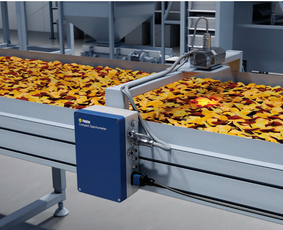
Bild 5: Endkontrolle Schokokeksüberzug vor der Verpackung mit dem Distanzmesskopf
