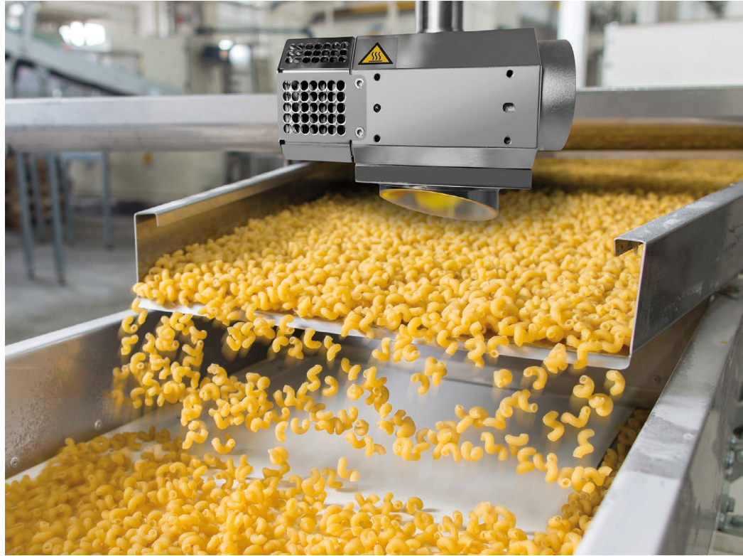
Bild 2: Der kompakte Distanzsensor für (hier Pasta-)Förderbänder oder Rutschen
