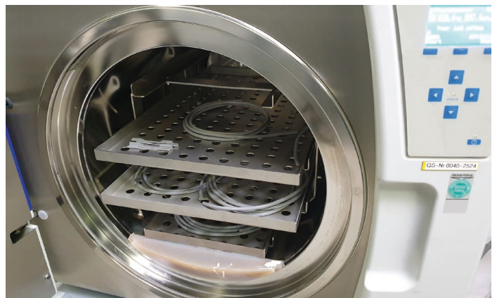
Bild 2: Blick ins Innere eines Autoklaven mit Kabeln
