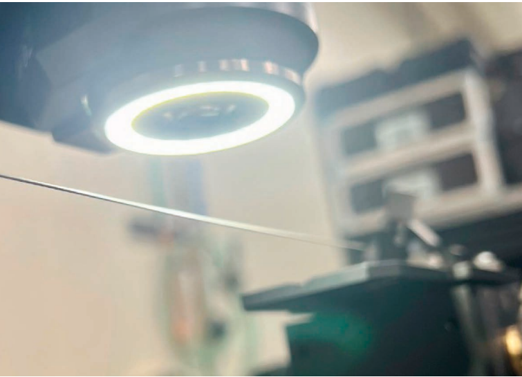
Bild 10: Digitales 3D-Mikroskop, das durch das Stapeln von Bildern aus verschiedenen Fokusebenen eine Tiefenschärfe erzeugt.
