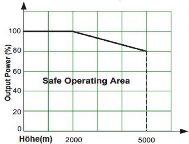
Beispiel für den Einfluss der Höhe über dem Meeresspiegel auf das Derating in einem Datenblatt
