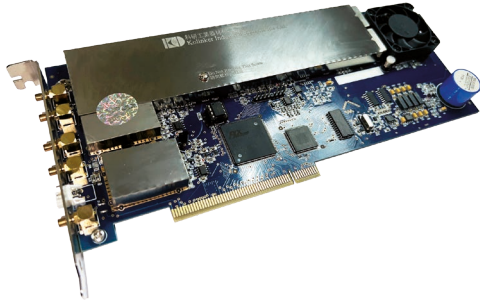
Bild 12: PC-Einsteckkarte KH1800 zur Quarzmessung (Kolinker)
