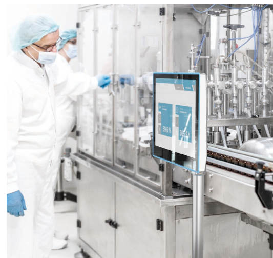
Einsatz eines hygienegerechten Edelstahl-HMIs in der Herstellung pharmazeutischer Produkte.
