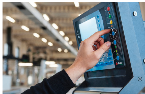
Bild 1: Klare Hierarchisierung von Bedienelementen – prozessorientiert und systematisch differenziert
