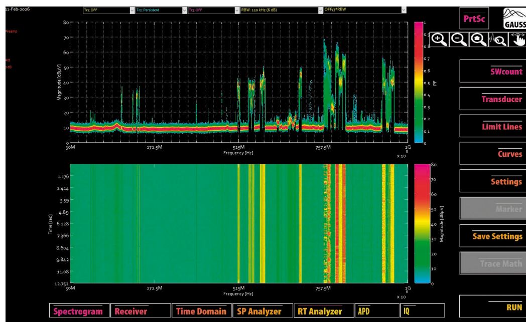
Bild 5: Ultra-high resolution Persistence Mode mit 1 GHz Bandbreite
