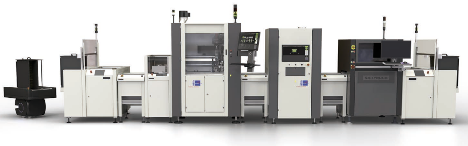
Bild 5: Individuelle Linienlösung – inkl. Coating-/Dispensing, Trocknung, Handling und Traceability © Rehm
