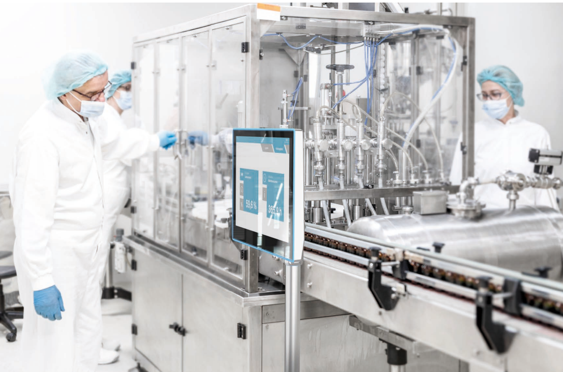
Einsatz eines hygienegerechten Edelstahl HMIs in der Herstellung pharmazeutischer Produkte Alle Bilder © ads-tec Industrial IT GmbH
