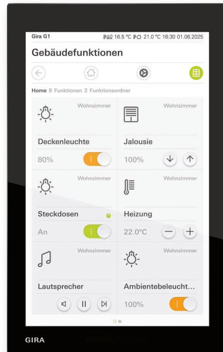
*Als zentrales Bediengerät steuert der neue Gira G1 Funktionen wie Licht, Heizung, Klima und Jalousien – intuitiv mit Touch- und Wischgesten. Darüber hinaus kann der Gira G1 als Wohnungsstation im Gira Türkommunikationssystem fungieren. Als SIP-Client lässt er sich zudem in Fremdsysteme integrieren.*
