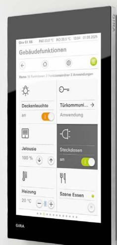
**Der Gira G1 XS ist die preisattraktive Einstieglösung für die Gebäudesteuerung mit dem Smart Home-System Gira One und dem Server Gira X1. Er kann zudem als Raumbediengerät in KNX-Anlagen ohne zentralen Server genutzt werden.**
