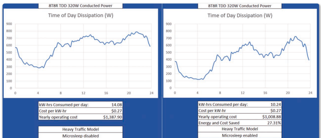
Bild 5: Leistungsaufnahme der O-RU-Anlage über einen Zeitraum von 24 Stunden
