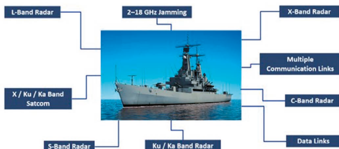
Bei der Radarkommunikation in Marineanwendungen kommen Frequenzen im S-Band, im L-Band, im C-Band sowie im X-Band bis hinauf zum Ku/Ka-Band zum Einsatz.
