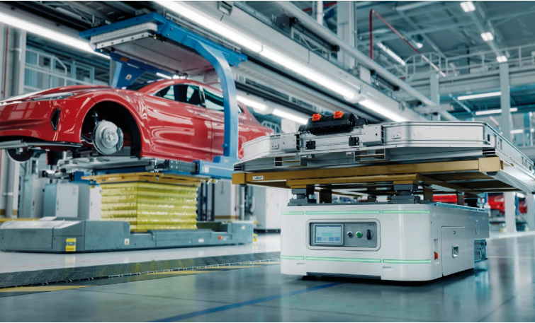
AGV in der Automobilindustrie
