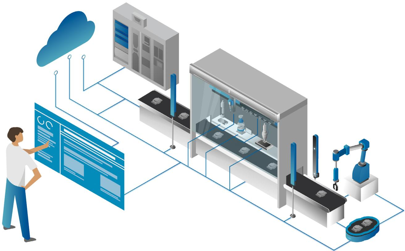
**SPE bietet eine einheitliche, Ethernet-basierte Kommunikation vom Sensor bis in die Cloud und ist eine Schlüsseltechnologie für Anwendungen in IIoT und Smart Factory.**
