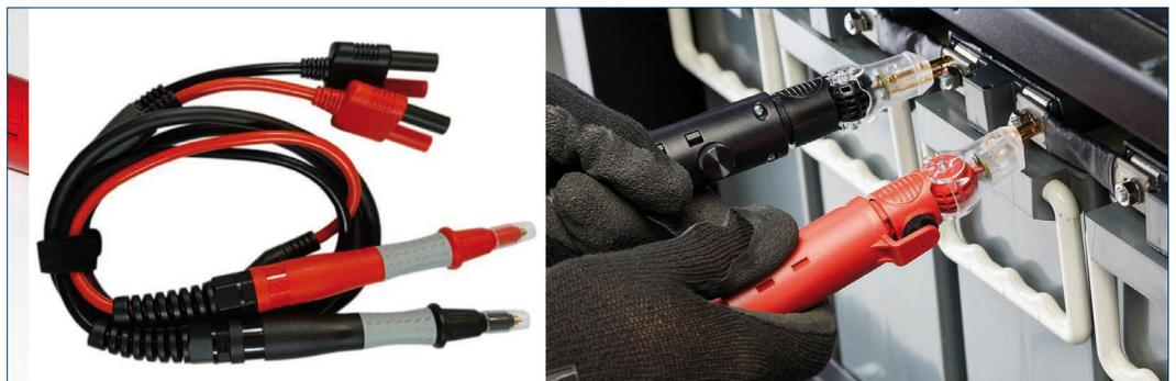
Kelvin- bzw. Duraprobe-4-Pol-Kontakt zur Widerstandskompensation und Kontakt an der Batterie
