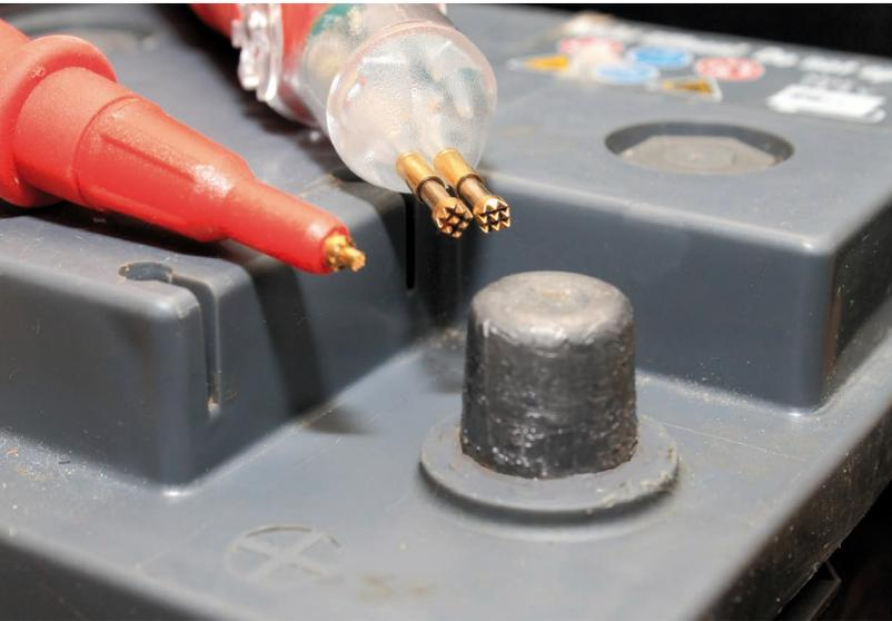
Die bewährte Leitwert-, bzw. Innenwiderstandsmesstechnik kann für alle Arten von Bleibatterien in USV-Systemen und Batteriespeichern genutzt werden. Um Veränderungen an der Batterie rechtzeitig zu erkennen, wird mit Hilfe einer erweiterten Messmethode der aktuelle Zustand des Batterieblocks korrekt dargestellt. Ergebnis: Mehr Aussagekraft als bisherige Methoden - Serviceeinsätze können deutlich effektiver durchgeführt werden. Batterien werden dann ausgetauscht, wenn es notwendig ist.
