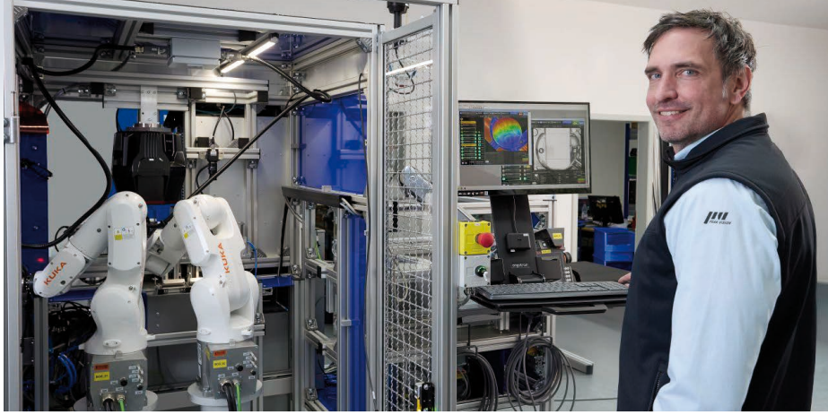
Markus Armgart bei einer Inbetriebnahme vor einer Automationszelle zur Oberflächenprüfung mit zwei ineinandergreifenden Robotern
