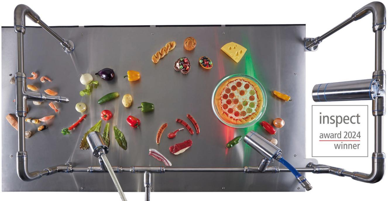
Der Montagebaukasten von autoVimation ermöglicht die flexible Integration von Bildverarbeitungstechnik in hygienisch anspruchsvolle Prozesse mit Hochdruck-Nassreinigung.
