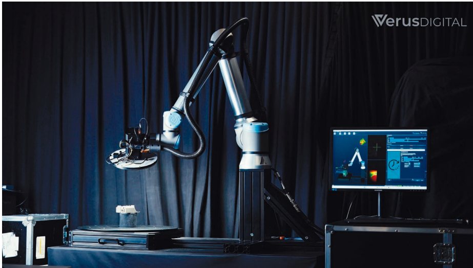
Bild 1: Eine Variante des vollautomatischen 3D-Erfassungssystems
