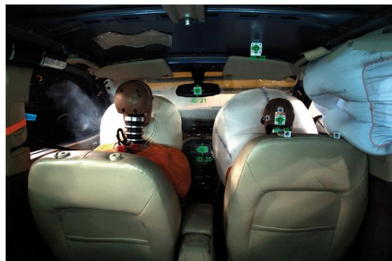
**Bild 4:** 3D-Bewegungsanalyse einer On-Board-Kamera beim Crash-Test
