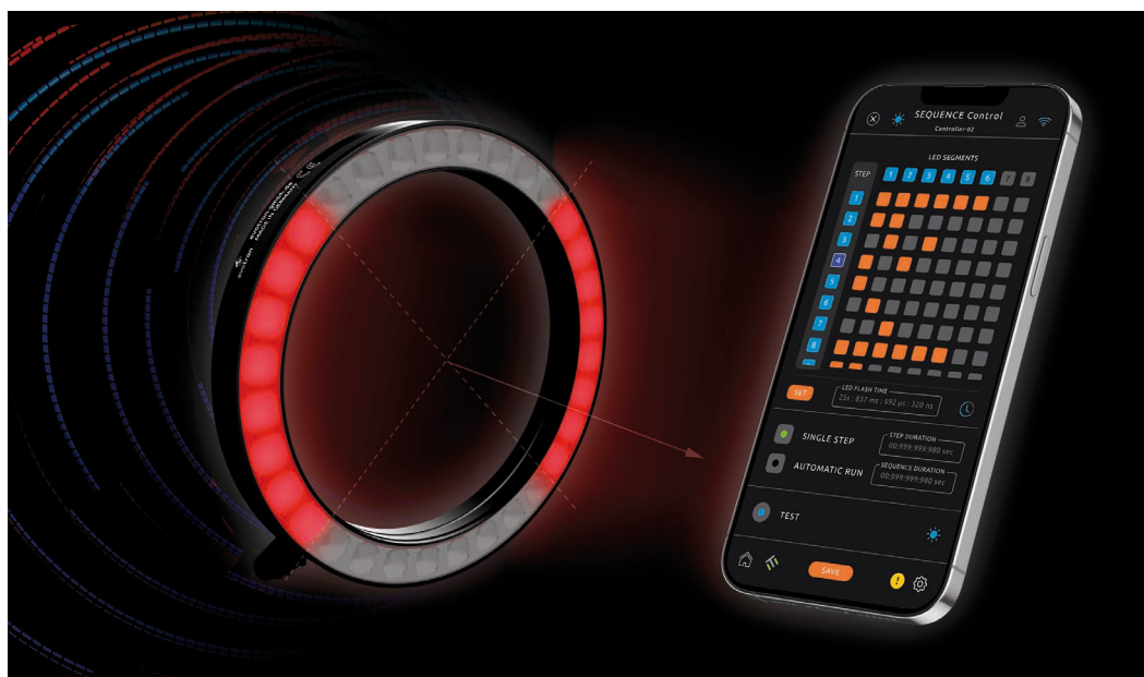
Bild 5: Mit der App „DCConfig“ können am in-Cable-Controller DCC2404 auch komplexe Beleuchtungsabläufe und Beleuchtungssequenzen eingestellt werden. Für die Einbindung in ein HMI lässt sich der Controller auch per API parametrieren.
