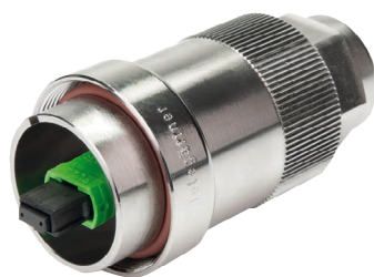
Bild 6: Seit Jahren bewähren sich TOC-Steckverbinder von Telegärtner mit RJ45, LC Duplex und MPO-Stecker in rauen Umgebungen im Außenbereich. Mit einer Drehbewegung wird das Gehäuse sicher verriegelt und gleichzeitig die Kabeleinführung zuverlässig abgedichtet.
