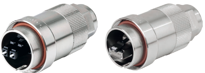
Bild 6: Seit Jahren bewähren sich TOC-Steckverbinder von Telegärtner mit RJ45, LC Duplex und MPO-Stecker in rauen Umgebungen im Außenbereich. Mit einer Drehbewegung wird das Gehäuse sicher verriegelt und gleichzeitig die Kabeleinführung zuverlässig abgedichtet.
