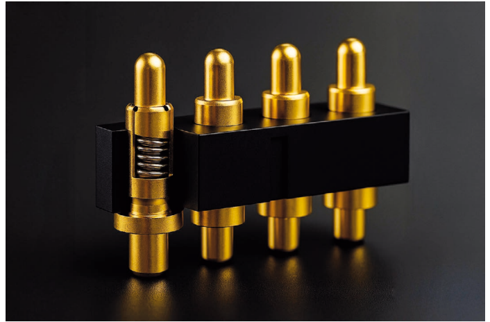
Bild 3: Aufbau eines Federkontaktes
