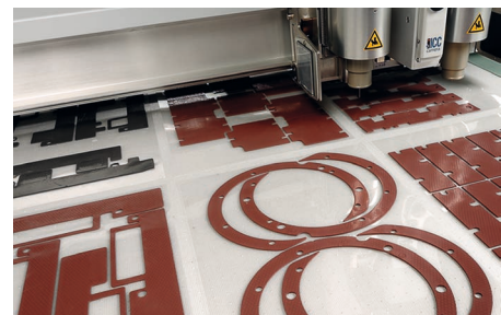
Bild 2: Einfache und schnelle Herstellung von kundenspezifischen Zeichnungsteilen mittels moderner Bearbeitungszentren, auch im 24 h Musterservice
