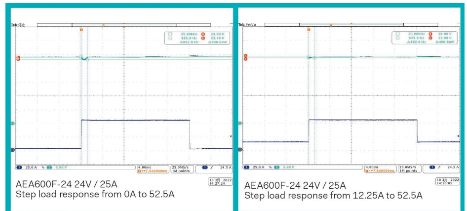
Bild 6: Lastsprungverhalten des COSEL AEA600F Netzteils © PRBX/COSEL
