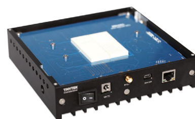
AiP FEM mit Motherboard und 8x8 Phased Array; der Local Oscillator ist nicht eingebettet.
