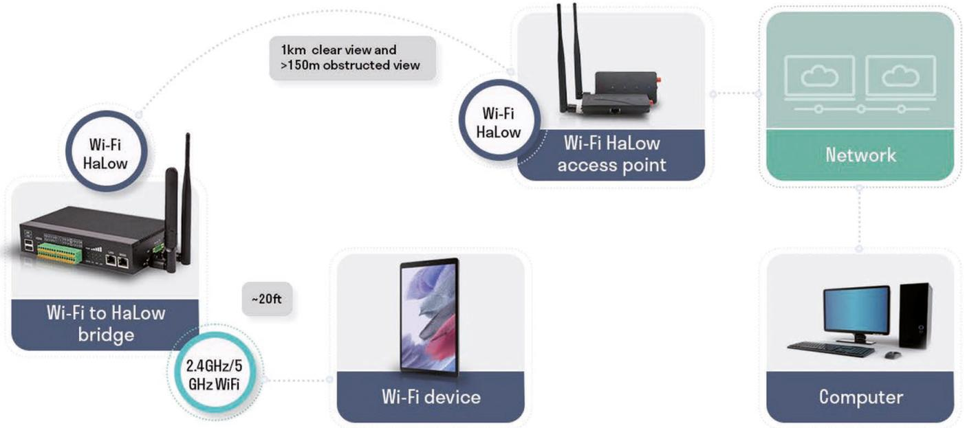
**Bild 4: HaLow ermöglicht Backbone-Verbindungen**
