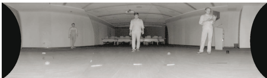
Bild 8: Zusammengesetzte IR-Daten mit einem Sichtfeld von 210°
