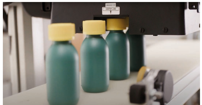
Versiegelung von Verschlüssen durch Erhitzen einer Klebefolie unter dem Deckel auf dem Flaschenhals
