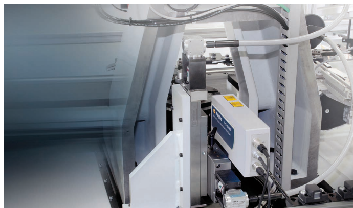
Bild 2: Null-Fehler-Produktion von Wälzlagern mit einem Industrie-Laservibrometer IVS-500.
