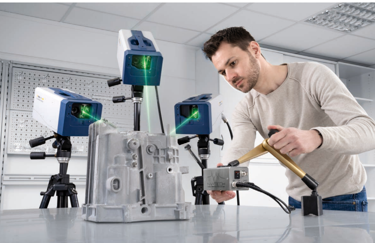
Bild 1: Messaufbau mit einem 3D Scanning Vibrometer bei einer Modalanalyse alle Bilder © Polytec GmbH
