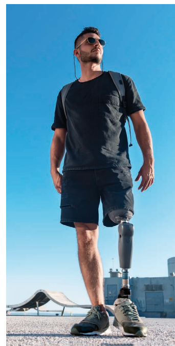
Winkelmessung in Knieprothesen: In mikroprozessorgesteuerten Knieprothesen ermitteln Sensoren in Echtzeit die Beugung des Knies. © Adobe Stock/Baumer
