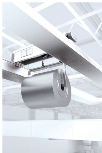
Gewichtsmessung am Portalkran: Hochpräzise Sensoren ermitteln die Durchbiegung der Traverse, an der die Last hängt, und damit deren Gewicht. © Baumer
