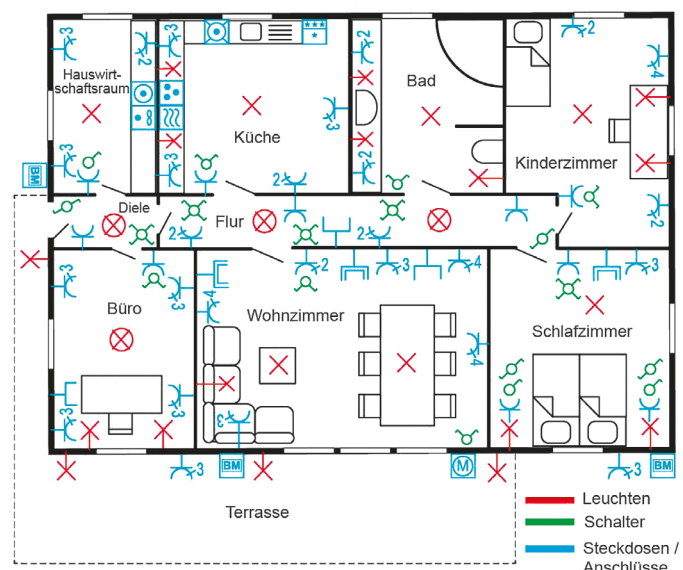
Elektroplanung einer Wohnung (Quelle: www.sanier.de/elektroinstallation/checkliste-elektroinstallation )
