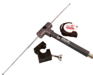
Bild 3: Variabler Halbwelldipol für hohe Frequenzen. Eine außermittige Speisung ist möglich
