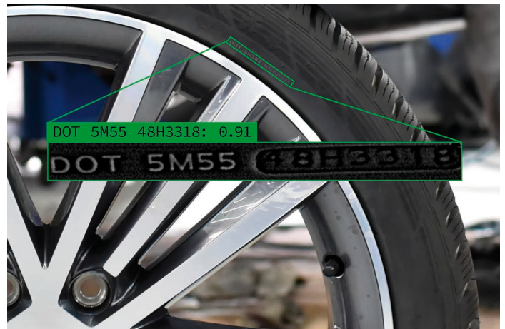
Bild 1: Die DENKnet OCR liest in vielen Anwendungsfällen auch ohne Feintuning schon sehr sicher, beispielsweise Reifennummern mit wenig Kontrast.
