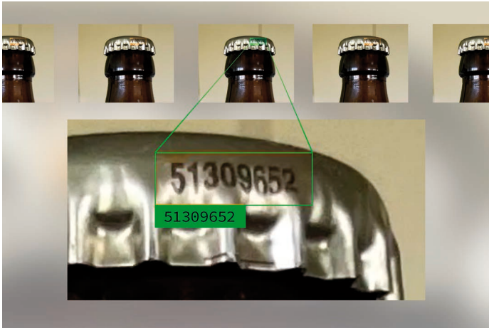
Bild 2: Stark verformte und kleine Nummern auf Kronkorken werden sicher gelesen
