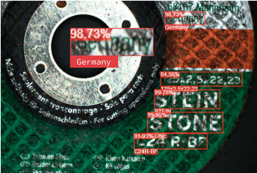
Bild 3: Auch Infos auf Trennscheiben mit erheblicher Überdrückung bei stark inhomogenem Hintergrund stellen kein Problem dar.
