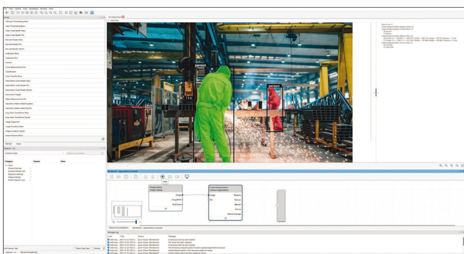
Bild 4: Einzelne Personen werden im Bild erkannt und die Regionen segmentiert, sodass Blurr-Effekte zur Wahrung des Datenschutzes erzeugt werden können
