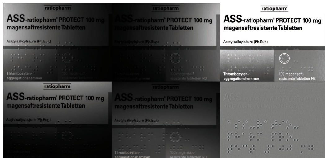
Bild 6 zeigt 2D-Grauwertbilder mit unterschiedlicher Einstellung und ein 3D-Neigungsbild. Hier sind die Erhebungen der Dots völlig unabhängig von der Bedruckung lesbar.
